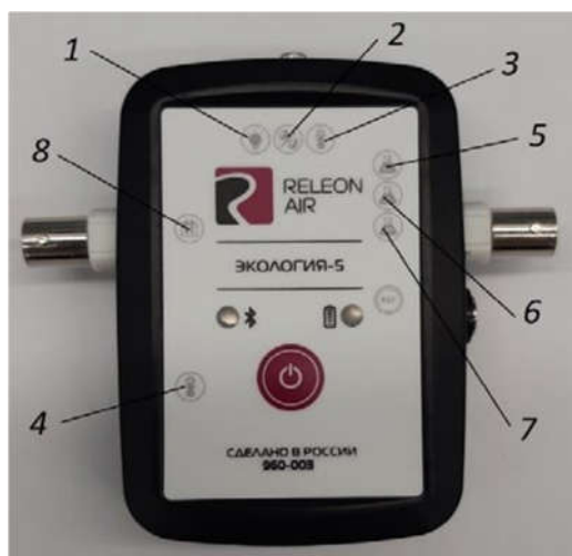
Рис. 3. Мультидатчик по экологии: 1 — освещённость, 2 — относительная влажность воздуха, 3 — температура окружающей среды, 4 — температура растворов, 5 — нитрат-ионы, 6 — хлорид-ионы, 7 — pH , 8 — электропроводность
